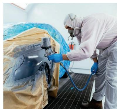
Les techniques de raccord pallient aisément la problématique liée à **la complexification des teintes constructeurs** et permettent d'**éviter les écarts de couleur après réparation**.
