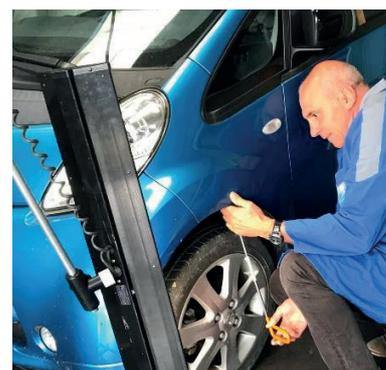
Le débouillage est **une technique de débouillage qui s'inspire du « débouillage sans peinture »** en mobilisant les mêmes outils. Il propose **une alternative aux techniques traditionnelles** (tas/marteau et tire-clous) et consiste à redresser 80 à 90 % d'une bosse avant peinture. Le débouillage est possible sur tous les éléments s'il y a un accès direct ou peu de démontage nécessaire.
