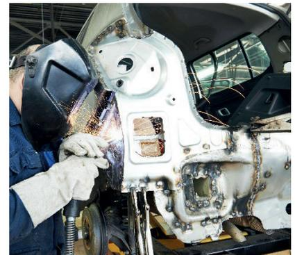
Pour les véhicules actuels, la tendance est à la réduction de poids, ce qui se traduit par **une augmentation de l'utilisation des aciers à haute résistance** (HLE, THLE, ...). Le réparateur se doit de redonner toutes les caractéristiques prévues par le constructeur lors de la conception du véhicule.
